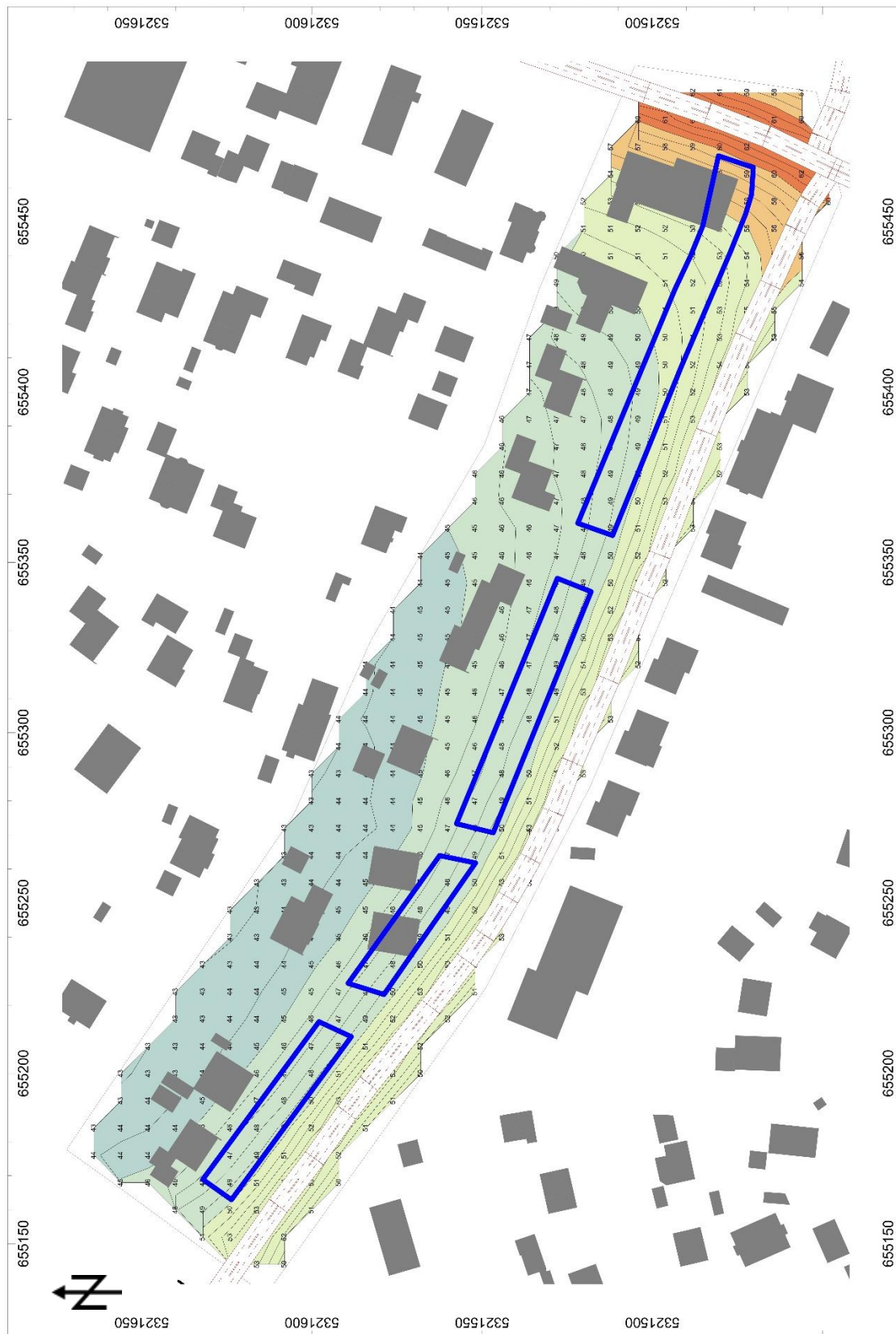
Abbildung 4: Beurteilungspegel Straßenverkehrslärm nachts, Berechnungshöhe 4 m über Boden
