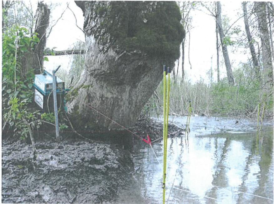
**Abb. 6.** Anschluss eines 12 V Akkugerätes an Zaun (rote Litze) und Erdpfahl (grüne Litze). Wegen des nassen Bodens funktioniert die Erdung auch mit wenig eingeschlagenem Erdpfahl.
